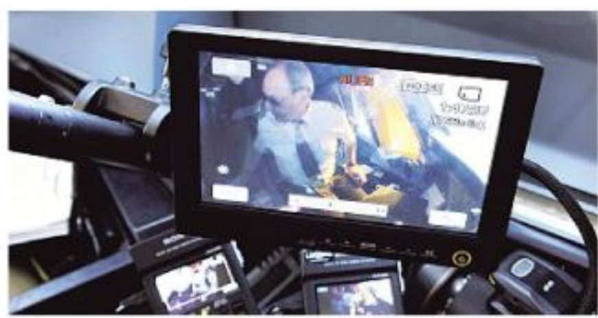
Innen und außen: Das Team von Pilotseye.tv hat den Airbus 380 im Cockpit mit sechs Kameras ausgestattet. Sie filmen sowohl nach innen als auch nach außen
